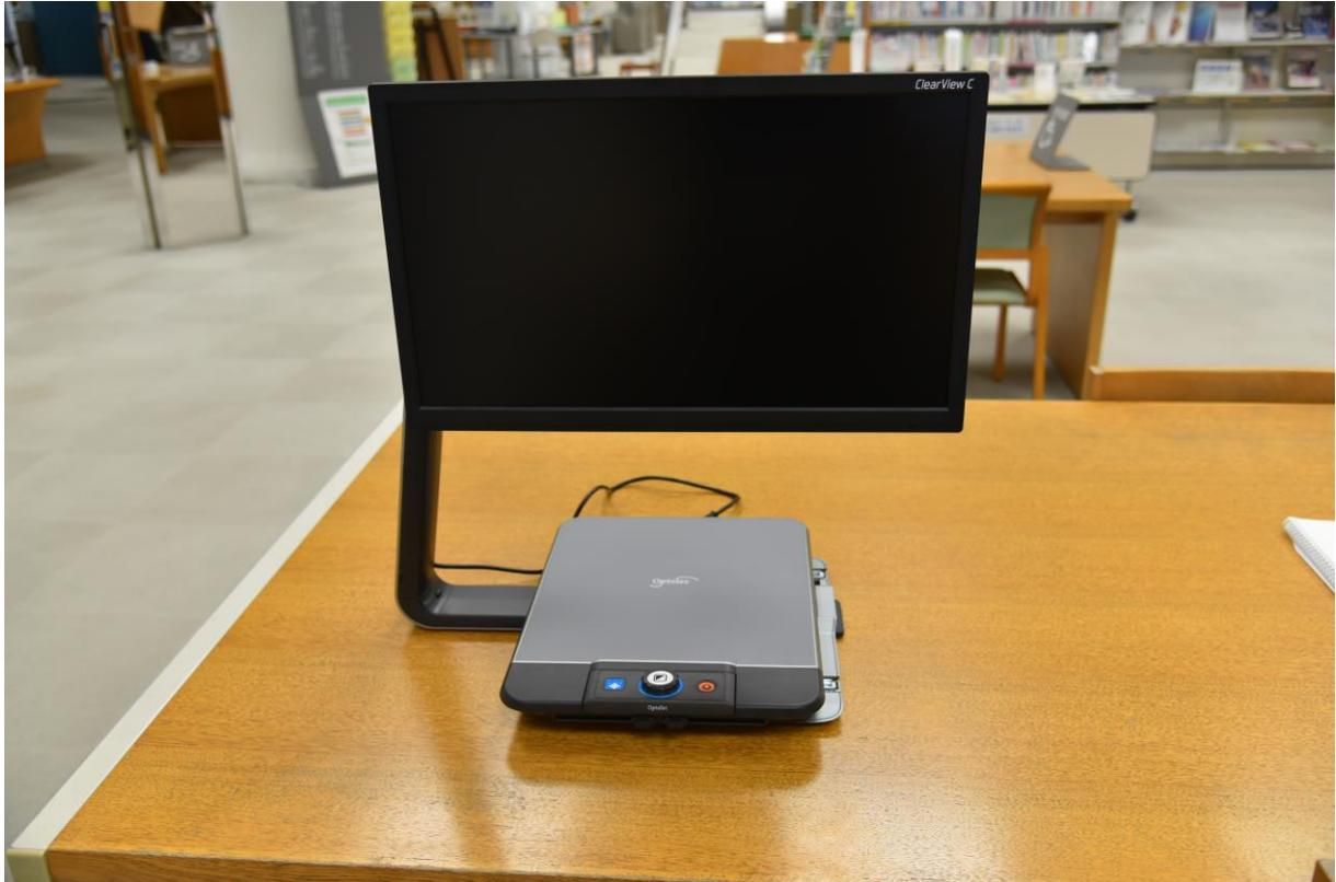
拡大読書器とはカメラで撮影した映像をモニターに表示する読書用機器で、簡単な操作で文字の倍率調節、白黒反転の切替などができます。
