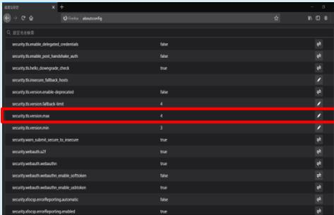
[高度な設定]の[Security.tls.version.max]欄の値を[3]に変更。変更するには、値をダブルクリックもしくは[  ]ボタンをクリック
